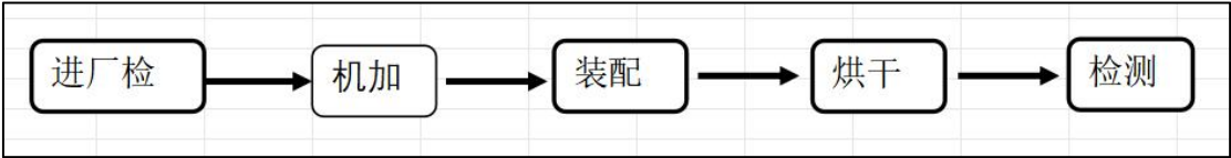
图 3 产品主要生产流程
